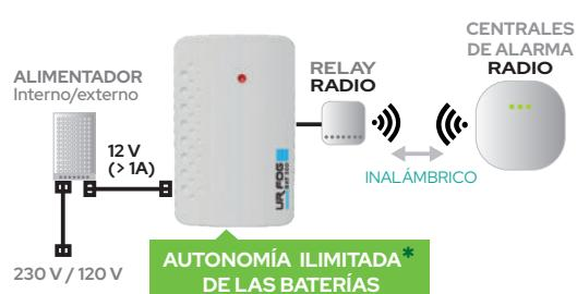
**1** Configuración con sistema de alarma híbrido
